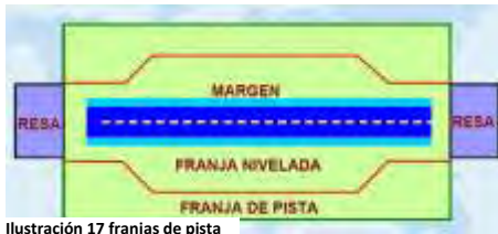
Ilustración 17 franjas de pista
