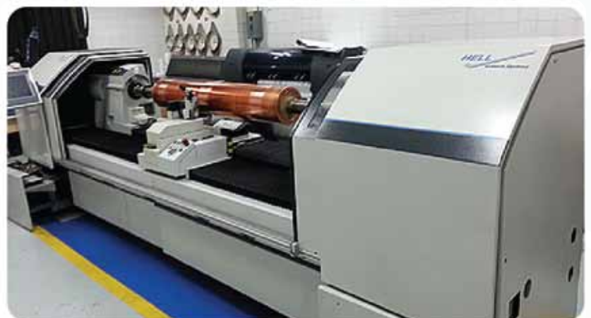
Equipo para grabar rodillos de rotograbado
