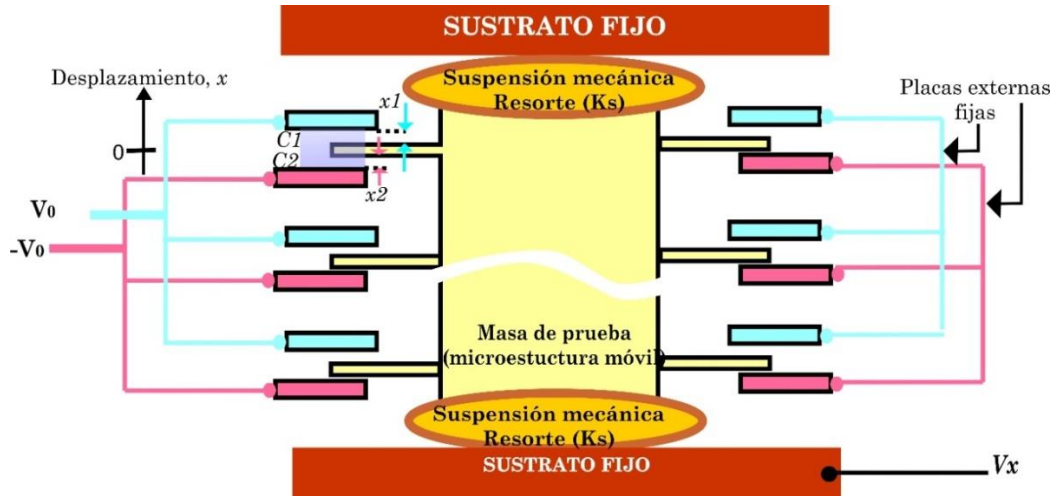
Figura 1.11. Esquema simplificado de un acelerómetro MEMS
