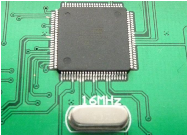
Figura 2.15. Circuito integrado de encapsulado cuadrado plano de 100 terminales.
