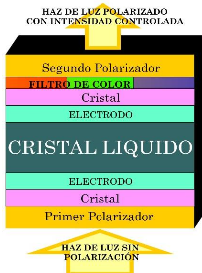
Figura 1.14. Estructura de una celda de un LCD.
