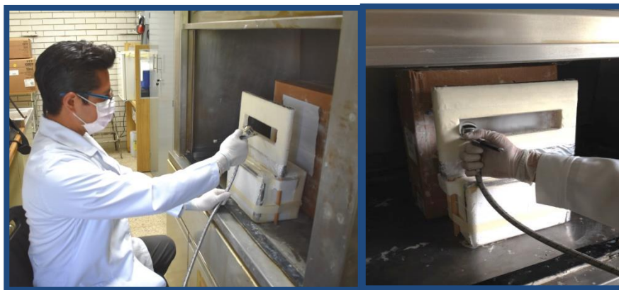
Figura 4. Fotografía de fabricación y depósito de fibras de PLA, fuente: elaboración propia
