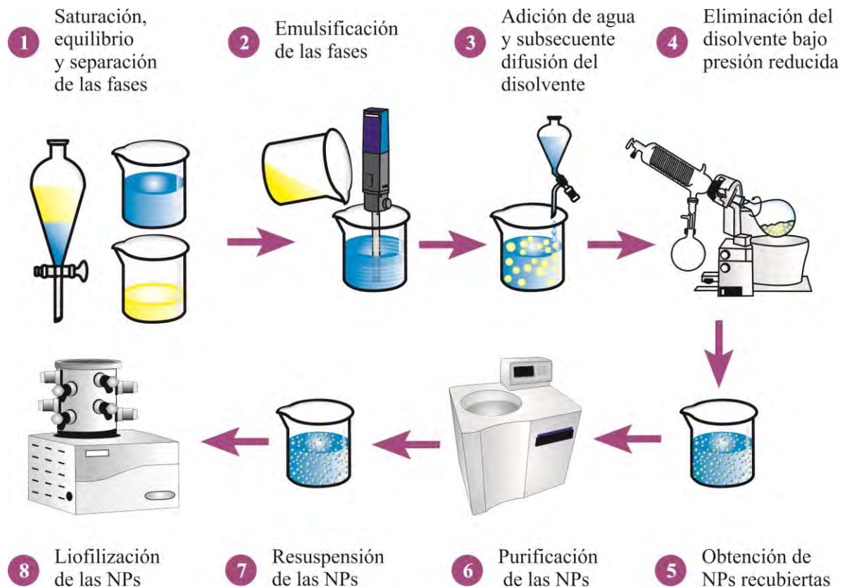
Figura 9. Representación esquemática del método de preparación de las nanopartículas.
