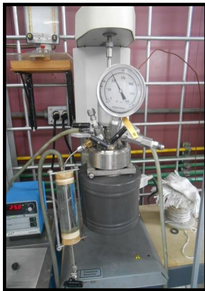
Figura 22. Reactor por lotes usado en la reacción de hidrodesulfuración de dibenzotiofeno.
