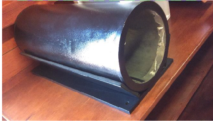
Figura 6.3 Se muestra el blindaje magnético utilizado para reducir efectos de magnetización.
