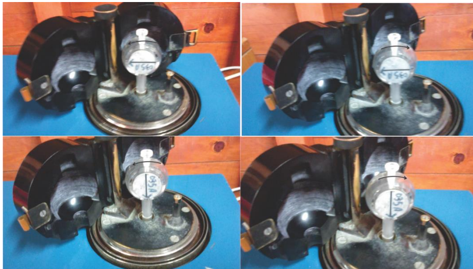
Figura 6.5 Se muestran las diferentes posiciones en las que se coloca cada muestra para medir la MRN.
