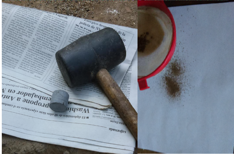
Figura 6.7 Pulverizado. Las muestras se pulverizaron poniéndolas dentro de un periódico y luego fueron golpeadas con un martillo de plástico. Finalmente se aseguró que tuviera el tamaño adecuado utilizando un tamiz de plástico.
