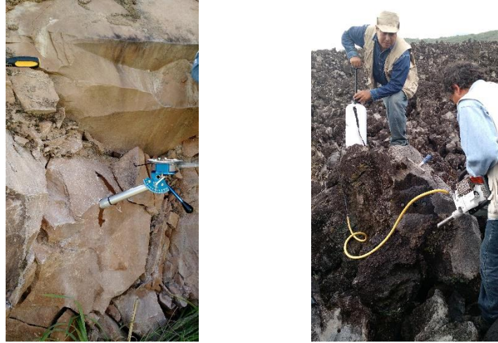
Figura 5.9 Extracción de los núcleos. A la izquierda se muestra el orientador de las muestras, a la derecha, una de las perforaciones realizadas para la extracción de las muestras.
