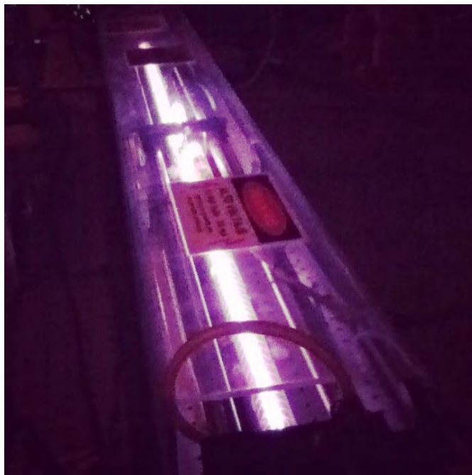
Figura 3.2. Láser de CO 2 sintonizable. Aquí se puede observar la fluorescencia del plasma al aplicar la descarga.
