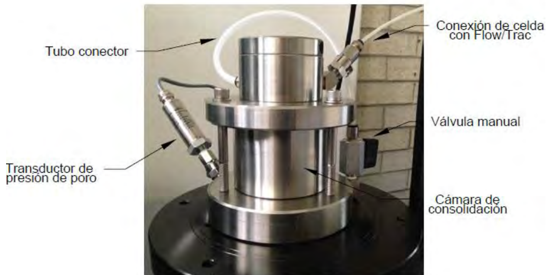
Figura 3.5. Celda de consolidación.
