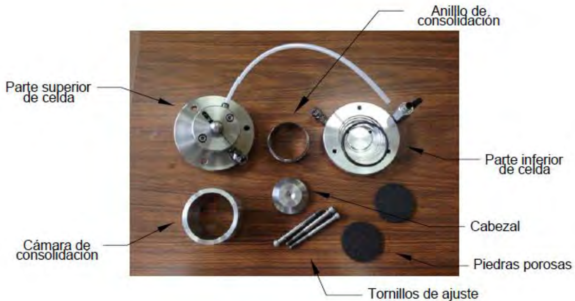
Figura 3.6. Piezas de celda de consolidación desmontada.
