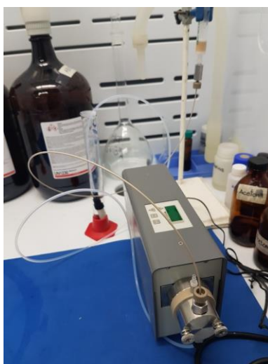
Figura 4.1. Sistema de extracción en fase sólida (EFS) empleando una bomba isocrática.
