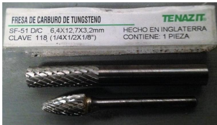
Figura 3.1 Fresas de Carburo de Tungsteno Marca TENAZIT
