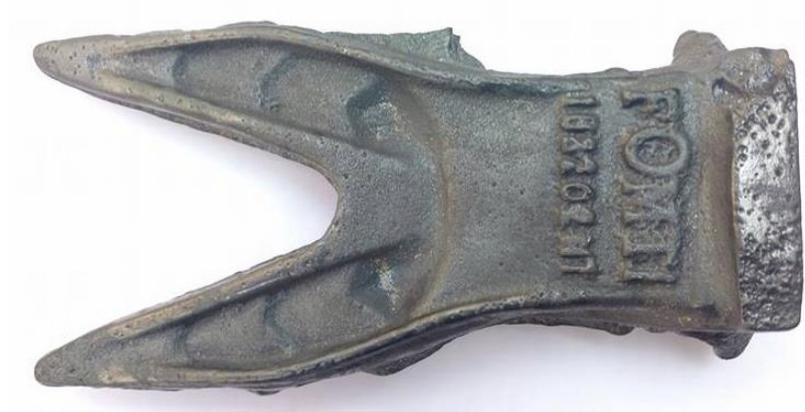
Figura 3.6 Se muestra un ejemplo de las puntas para excavadora obtenidas por fundición de hierro nodular con carburos aleados de Cr y V
