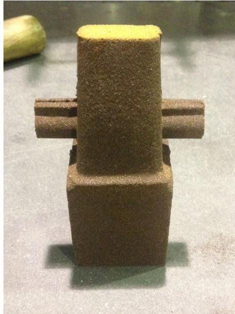
Figura 3.3 Corazones de arena Shell para la punta para excavadora
