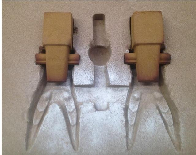
Figura 3.4 Molde de arena de punta para excavadora con corazones de arena Shell.
