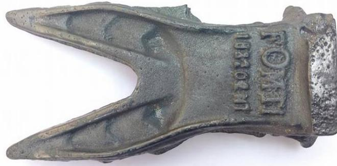
Figura 3.6 Muestra un ejemplo de las puntas para excavadora obtenidas por fundición de hierro nodular con carburos aleados de Cr y V.
