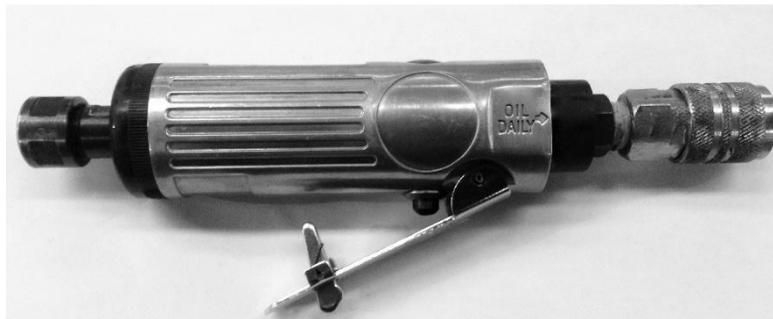
Figura 3. Rectificadora Neumática (Mototool) Marca ADIR
