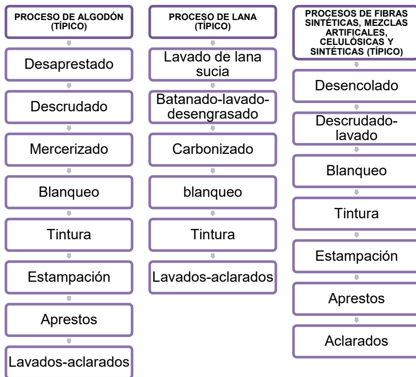
Fig.2.3 Diagramas de bloques de distintos tipos de telas creado por Diana Becerril Mejía con datos obtenidos de Ing. Manuel Viejo Zubicaray, Bombas (teoría, diseño y aplicaciones) , Ed. Limusa, Segunda Edición, Mexico, D.F. 1975).
