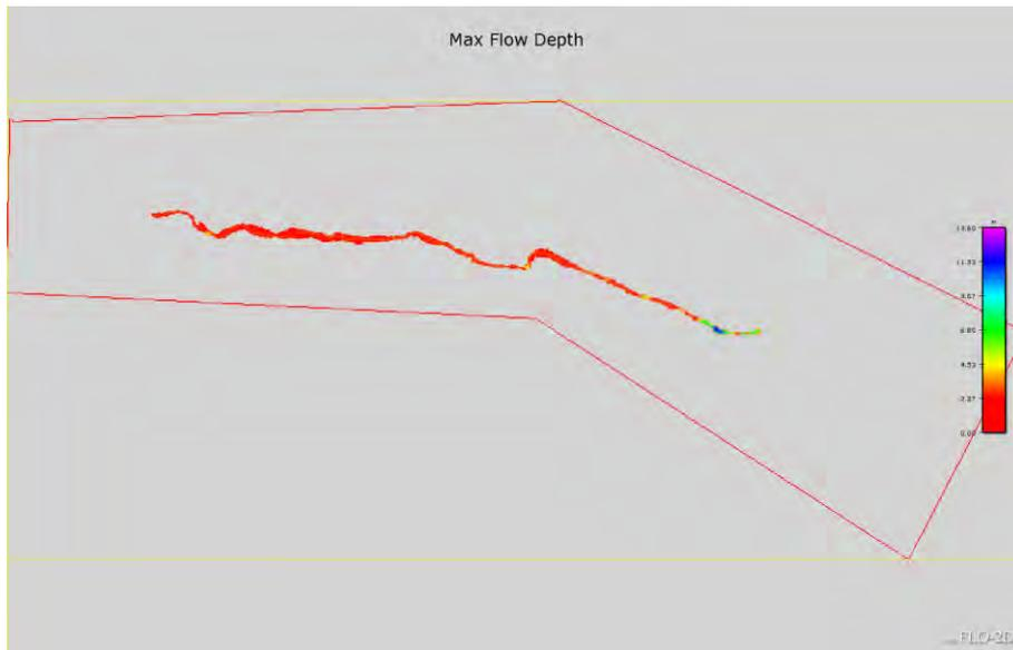
Figura 5. 23. Máxima profundidad del flujo (Max Flow Depth), obtenida con FLO-2D y visualizada mediante Mapper ++.
