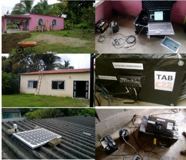
Figura 4.6. Equipo utilizado para el registro de microtemores y sismos ubicado en la población C22 José María Pino Suárez (Lermo y Escobar, 2013).
