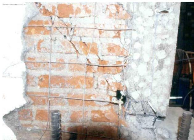
Figura 2.6. Falla de castillo por tensión diagonal (CENAPRED, 2013).
