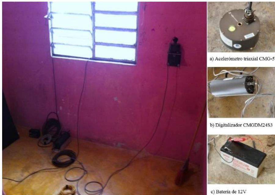
Figura 4.48. Instalación y equipo utilizado para realizar las pruebas de vibración ambiental en las viviendas del estudio (Cecilio *et al.*, 2015).
