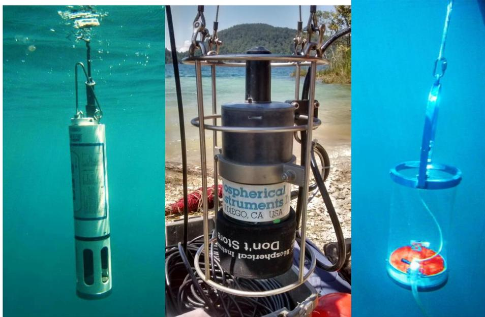
**Fig. 2.** A la izquierda, sonda multiparámetro Hydrolab DS4 sumergida en agua (Fotografía de Rigel González). En medio, perfilador de fluorescencia natural Biospherical PNF-300. A la derecha, botella hidrográfica marca UWITEC de 5 L sumergida en agua (Fotografía de Rigel González).
