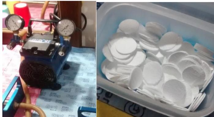
**Fig. 3.** A la izquierda, bomba de vacío marca Millipore. A la derecha, filtros GF/F marca Whatman.
