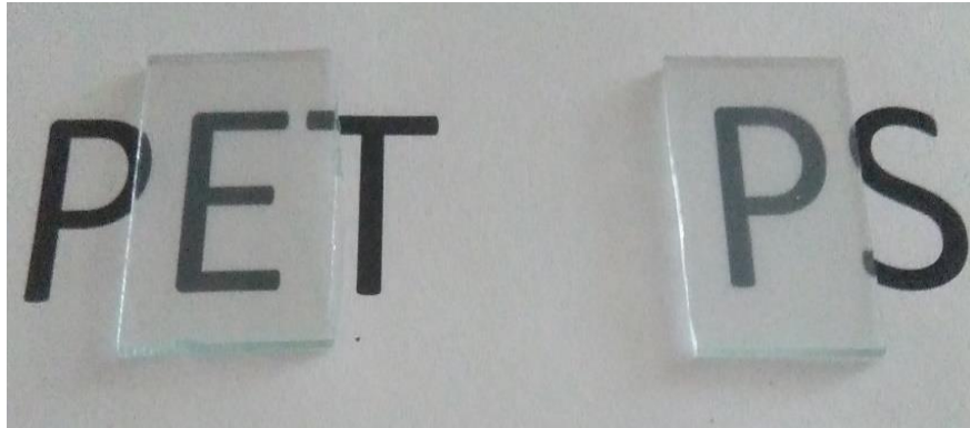
Figura 5.7. Se muestran las películas de PET y PS que tienen una transparencia de aproximadamente el 90%.
