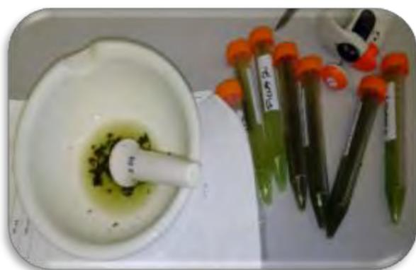
Figura 3.11 Muestra preparada para la determinación de pH en mortero (izq.) y tubos Eppendorf de 15 mL. (der.).
