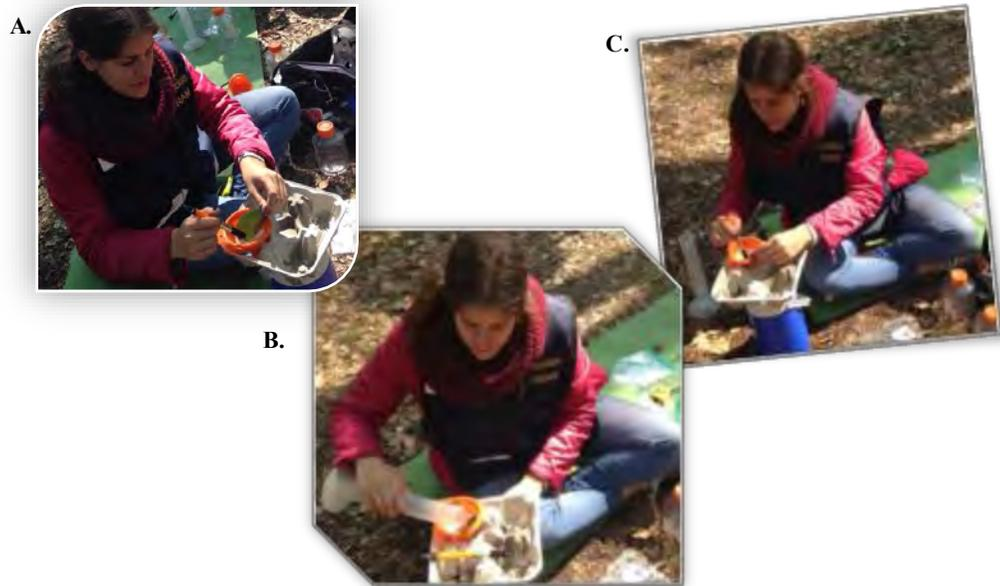
Figura 3.8 Obtención de PM para la estimación de intercepción de hojas de los árboles muestreados. Proceso de lavado (A. y C.) y filtrado (B.) en las hojas.
