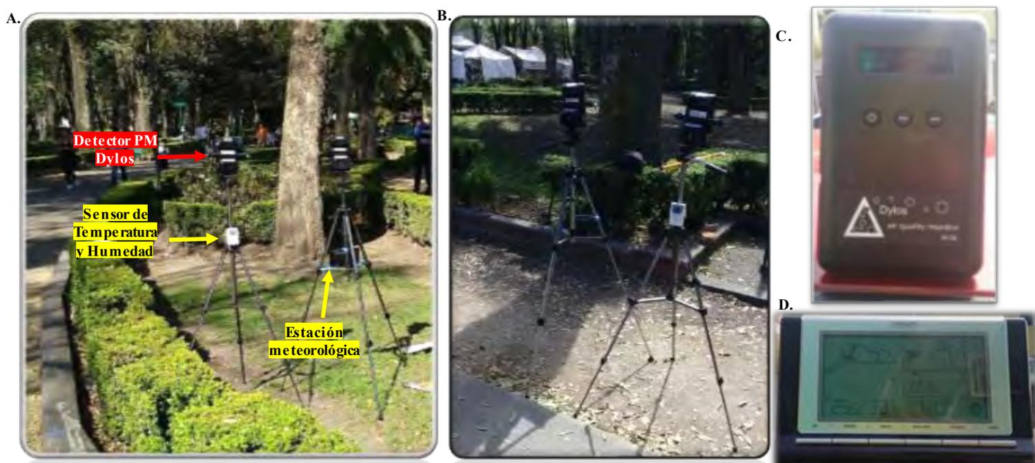
Figura 3.7 Experimento para la determinación de PM en un cuadrante del Parque Francisco Villa. Posición de monitores en la zona de estudio con la estación atmosférica y sensor montados (A. y B.). Detector nefelométrico de PM Dylos DC1700 (C.) y estación meteorológica Oregon Scientific WMR89 (D.)
