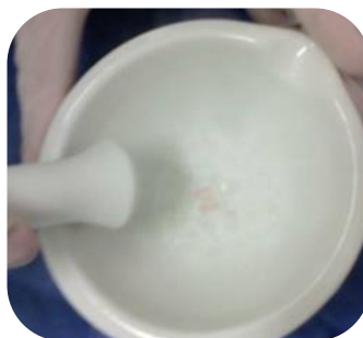
Figura 8. Hueso en nitrógeno líquido pulverizado con mortero y pistilo
