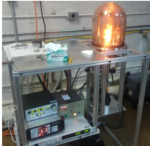
Figura 3.6. Sistema de evaporación térmica de metales usada para deposición de películas delgadas.
