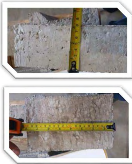
Fig. 6.3.- Obtención de las características geométricas de los adoquines rectangulares.
