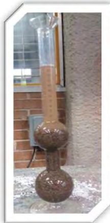
Fig. 3.17.- Obtención de la densidad de la arena en estado s.s.s. a través del frasco Chapman
