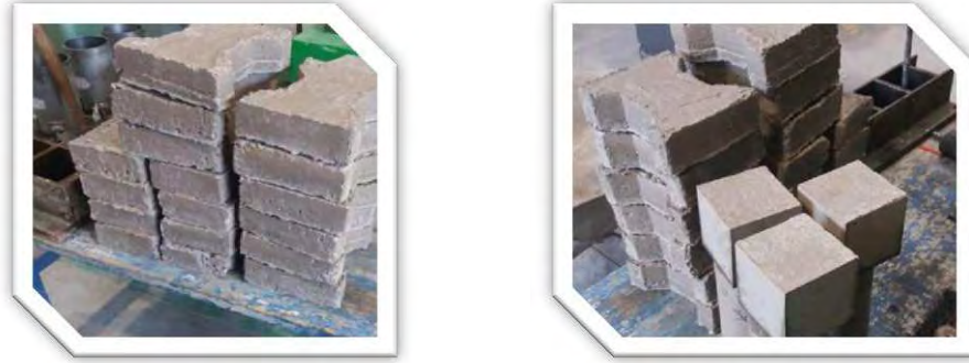
Fig. 5.23.- Se observa que al momento de desmoldar los adoquines, las piezas tienden a deformarse debido al alto revenimiento de la mezcla, por otra parte los cubos se muestran con una mayor uniformidad en el acabado.
