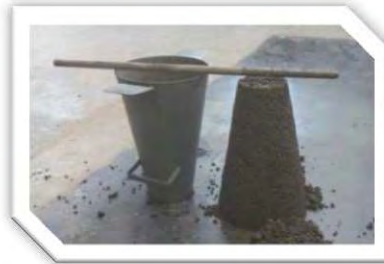
Fig. 5.32.- La mezcla presenta un revenimiento ideal para la fabricación de los adoquines.
