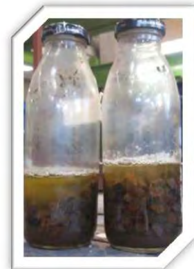
Fig. 3.12.- Del lado izquierdo preparación de las muestras y del lado derecho se observa el agregado grueso después de 48 horas de haberse sumergido en ácido muriático.
