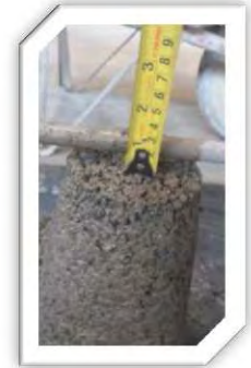
Fig. 5.33.- Revenimiento de la mezcla es de 1.5cm.
