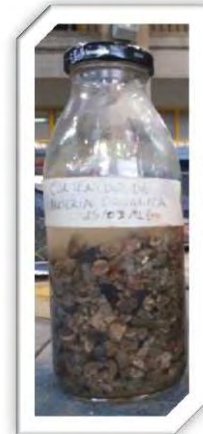
Fig. 3.11.- Del lado derecho se observa que la solución de hidróxido de sodio presenta un color más claro después de haber sumergido agregado grueso por 24 horas.
