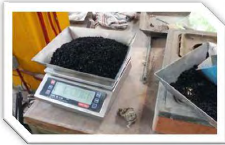
Fig. 5.26.- Dosificación del caucho en granulo.
