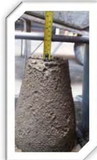
Fig. 5.42.- Revenimiento de la mezcla es de 4.5 cm.
