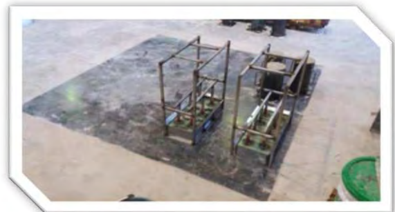
Fig. 5.9.- Adoquineras ya ensambladas.
