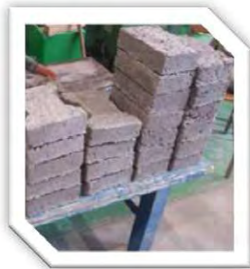
Fig. 5.44.- Preparación de las piezas para ser ingresadas a la cámara de curado.
