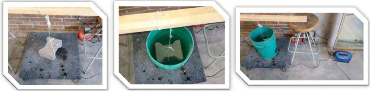
Fig. 6.30.- Los adoquines se ataron a un cordón de plástico, se verifica que los adoquines no toquen las paredes del recipiente en el cual se encuentran sumergidos y se registra la masa del adoquín en estado s.s.s. sumergido en agua cuya masa es conocida.
