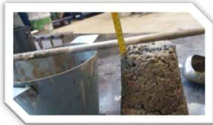
Fig. 5.11.- Verificación del revenimiento de la mezcla.
