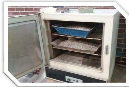
Fig. 3.5.- Secado en horno de los agregados reciclados.
