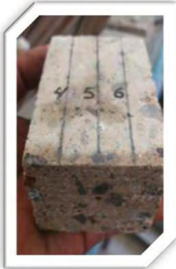
Fig. 6.22.- Desgaste que presentan las probetas después del ensayo.
