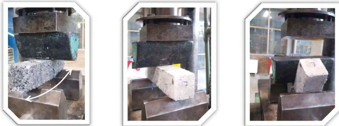
Fig. 6.29.- Del lado izquierdo se puede apreciar la deformación que presentaron las probetas que contienen caucho, en la imagen del centro e izquierda se observa una probeta que no contiene caucho, la cual no mostro una deformación tan notable como en la primera.
