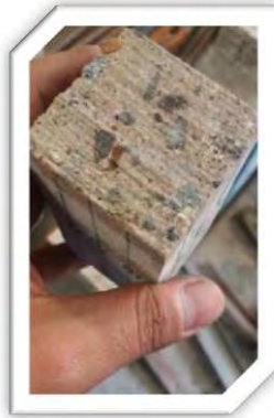
Fig. 6.22.- Desgaste que presentan las probetas después del ensayo.
