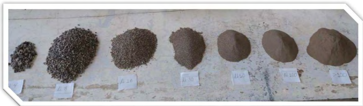
Fig. 3.8.- Distribución de las partículas del agregado fino posterior al cribado ( Muestra 1 ), de izquierda a derecha se tienen los tamaños No.4, No.8, No.16, No.30, No.50, No.100 y lo que pasa No.100.
