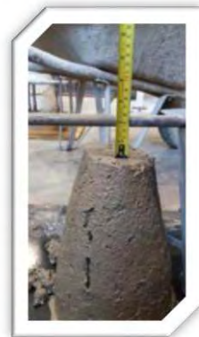
Fig. 5.15.- Verificación del revenimiento de la mezcla.
