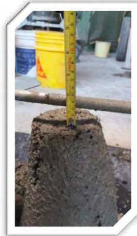
Fig. 5.27.- Verificación del revenimiento de la mezcla.
