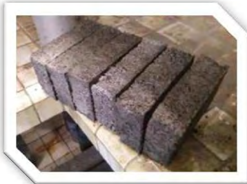
Fig. 5.39.- Los adoquines presentan una mejor uniformidad geométrica.
