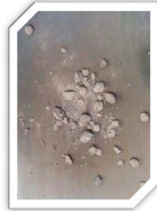
Fig. 3.20.- Al separar el material fino del más grueso se observa que aún existe humedad en el interior de las partículas apelmazadas.
