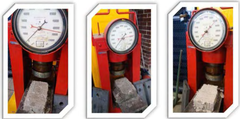
Fig. 6.4.- Resistencia a compresión en adoquines rectangulares.
