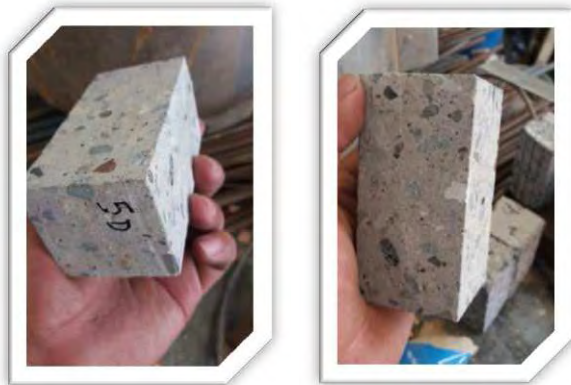
Fig. 6.17.- Muestras prismáticas para ser sometidas a la prueba de resistencia a la abrasión.
