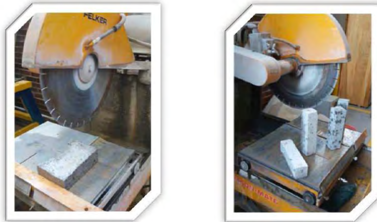
Fig. 6.28.- Labrado de muestras para el ensaye de resistencia a flexión.
