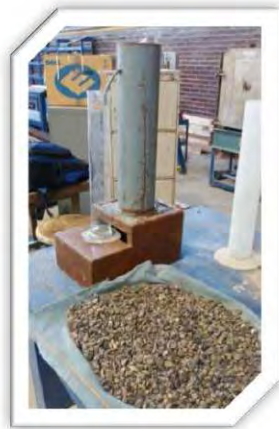
Fig. 3.14.- Determinación de la densidad de la grava mediante el uso del picnómetro de sifón.
