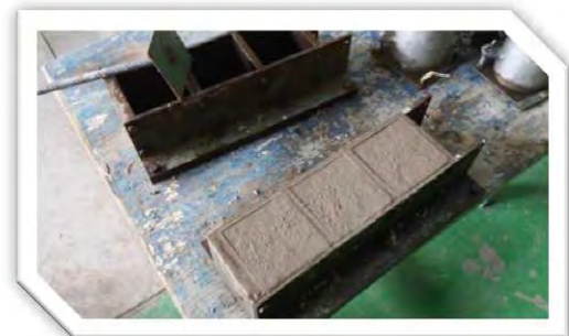
Fig. 5.22.- Elaboración de los especímenes cúbicos.
