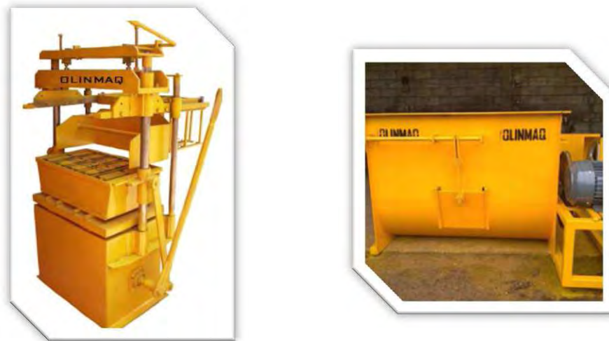
Fig. 7.1.- Equipo indispensable para la fabricación de adoquines, del lado izquierdo la máquina adoquinera y del lado derecho la mezcladora tipo horizontal
