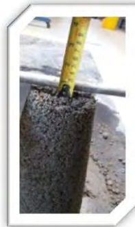
Fig. 5.37.- Revenimiento de la mezcla es de 1 cm.
