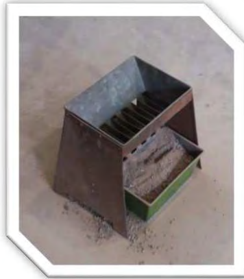
Fig. 3.4.- Cuarteo mecánico de los agregados reciclados.
