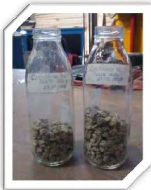
Fig. 3.12.- Del lado izquierdo preparación de las muestras y del lado derecho se observa el agregado grueso después de 48 horas de haberse sumergido en ácido muriático.
