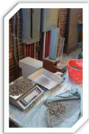
Fig. 3.14.- Determinación de la densidad de la grava mediante el uso del picnómetro de sifón.
