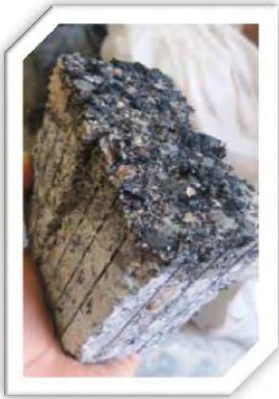
Fig. 6.24.- Probetas que no pudieron ensayarse adecuadamente debido a que por el contenido de caucho se frenaba el disco metálico de la máquina.
