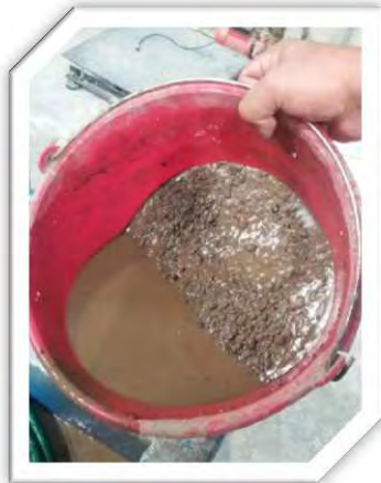
Fig. 3.16.- Apariencia de la arena reciclada después de ser sumergida en agua por 24 horas para que fuera saturada.
