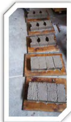
Fig. 5.21.- Apariencia de los adoquines después de haber sido desmoldados.
