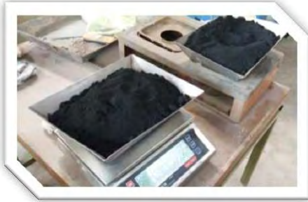
Fig. 5.25.- Dosificación del caucho en polvo.
