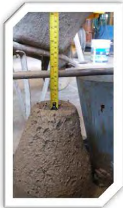
Fig. 5.17.- Verificación del revenimiento de la mezcla.
