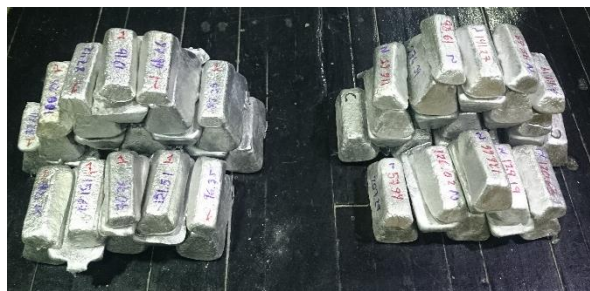
Figura 17. Imagen de las cargas de aluminio utilizadas para la experimentación, lingotes e 250 \text{ g} \pm 50 g.
