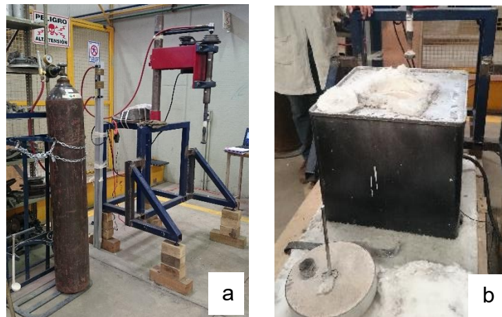
Figura 23. Imagen de a) equipo montado del rotor inyector, b) horno de piso y de resistencia utilizado para la experimentación.
