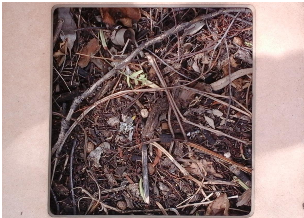
Figura 5. Cuadro de 20 x 20 cm para caracterizar la superficie del suelo.
