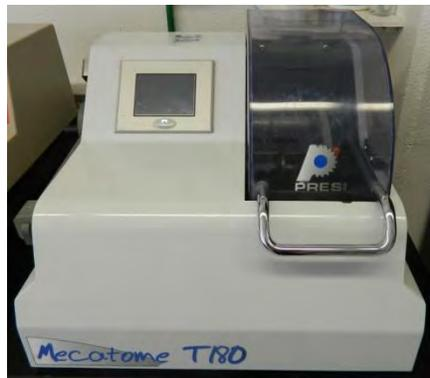
**Imagen 5.31** Cortadora utilizada para la obtención de muestras de la placa **Al/Gf/A100/PVPh/SG**
