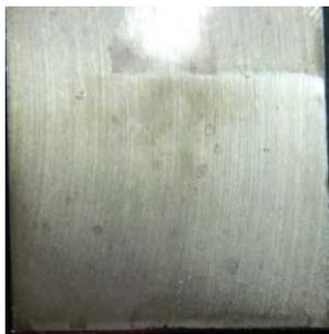
**Imagen 5.22 AA2024-T3 con aminosilano, grafeno depositado por electro-spray, PVP hidratado y sol-gel.**
