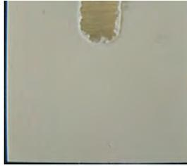
**Imagen 5.1. Aleación aluminio AA2024-T3 con recubrimiento de PVP electrohilado.**
