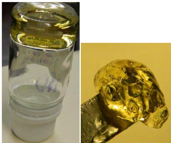
**Imagen 5.26. Izquierda: vial de aminosilano 3.85% en PVP mostrado boca abajo, derecha: gel obtenido de la disolución**
