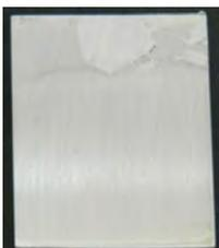
**Imagen 5.9. AA2024-T3 con aminosilano con ácido, PVP, grafeno 3% y sol gel híbrido.**
