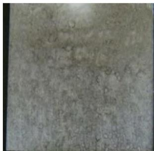
**Imagen 5.19 AA2024-T3 con grafeno depositado por electro spray, PVP hidratado y sol-gel.**
