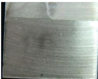
Imagen 5.25 AA2024-T3 grafeno depositado por electro-spray, aminosilano y sol-gel.
