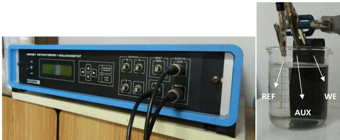
Imagen.4.2. Potenciostato utilizado y celda de reacción
