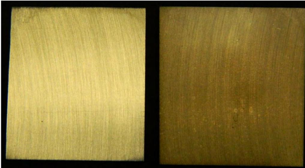
**Imagen 5.17. A) Aleación AA2024-T3 y B) Aleación AA2024-T3 con Grafeno depositado por electro spray por 40min.**
