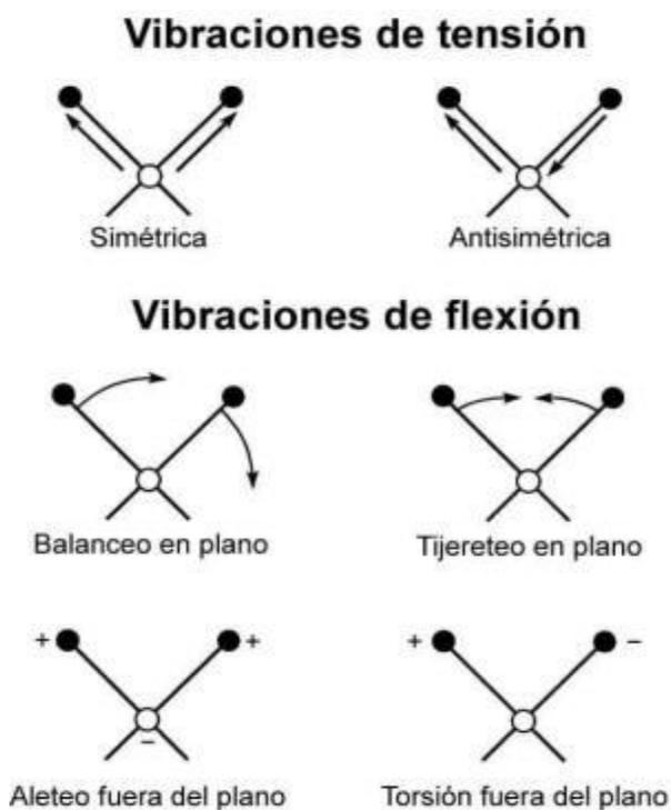
Imagen 3.15. Representación de los diferentes tipos de vibraciones moleculares.
