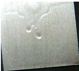
**Imagen 5.20 AA2024-T3 con PVP hidratado, grafeno depositado por electro-spray y sol-gel.**
