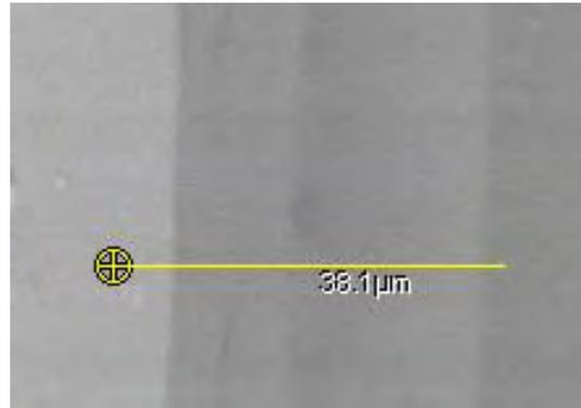
**Imagen 5.36** Sección transversal para análisis lineal de abundancia de elementos
