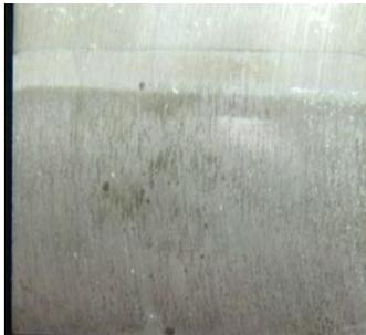
**Imagen 5.24 AA2024-T3 grafeno depositado por electrospray, aminosilano, PVP hidratado y sol-gel.**
