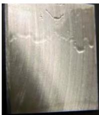
**Imagen 5.15. Aluminio con disolución 1:1 aminosilano: Chemguard® sin ácido, PVP grafeno 3% hidratado inmediatamente y sol-gel**
