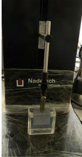
**Imagen 4.4. Equipo utilizado para deposición por inmersión**
