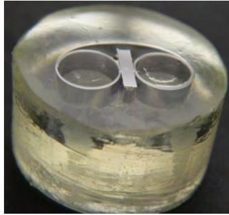
**Imagen 4.8** Placa de aluminio con recubrimiento embebida en resina
