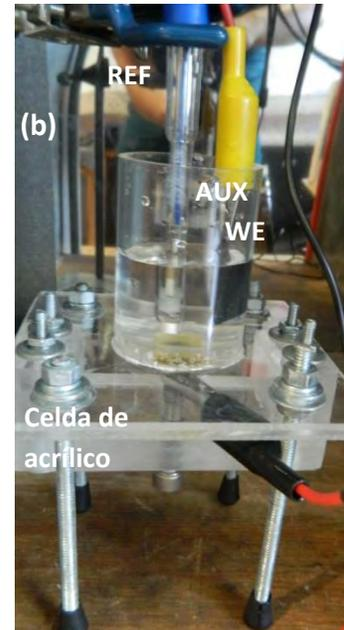
Imagen 4.7. a) Potenciostato utilizado y b) arreglo de electrodos en celda electroquímica.
