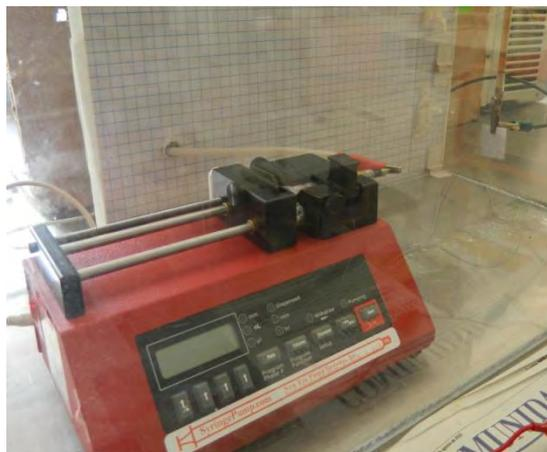
Imagen 4.3. Sistema de electrohilado para PVP, vista lateral
