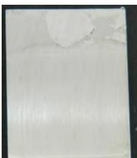
**Imagen 5.3. Aleación aluminio AA2024-T3 con recubrimiento de aminosilano 6020: Chemguard® 1:1 y PVP electrohilado.**
