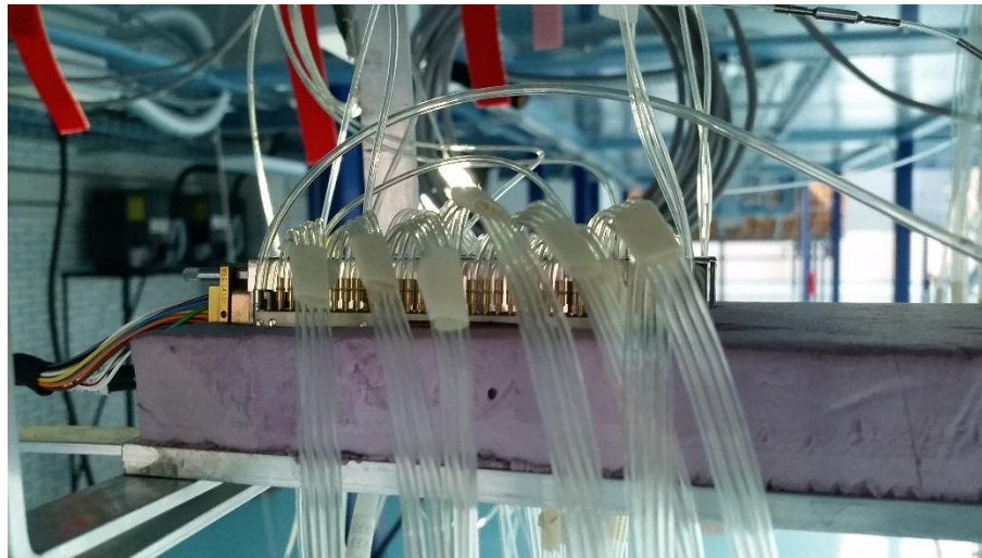
Figura 19a: Líneas de lectura conectadas a 1 Zoc de 32 canales
