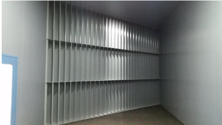
Figura 7: Imagen de los álabes guía del túnel de viento
