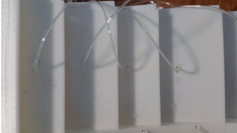
Figura 16a: Colocación de las líneas de lectura en las tabletas de cada arco
