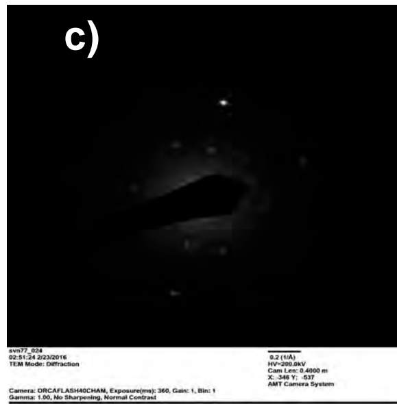
Fig .4-35. Imagen TEM a)150000X, b) 200000X y b) difracción de electrones para la muestra crecida a 6 Pa
