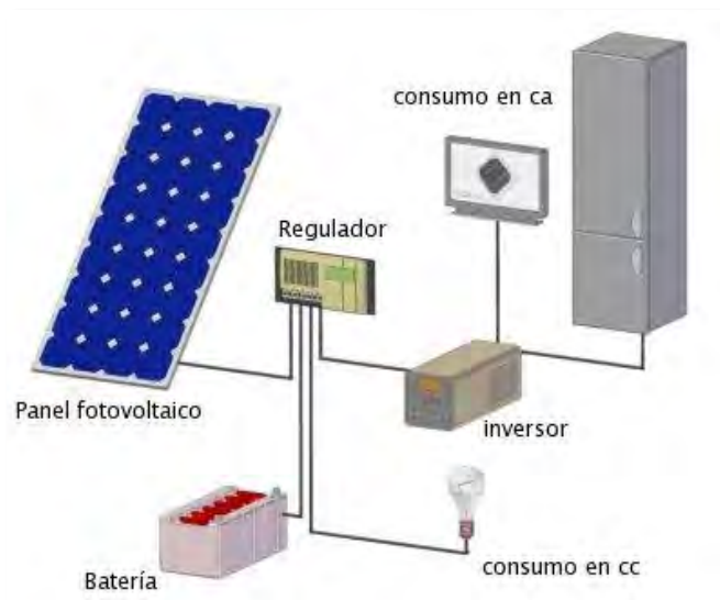
Figura 1.19 Sistema aislado a la red [Fuente: Portal SEENERGY MEXICO.com, 2014]
