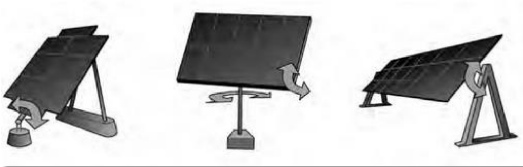
Figura 1.15 Sistema de seguimiento en uno y dos ejes [Fuente: Corporativo Solar choice]
