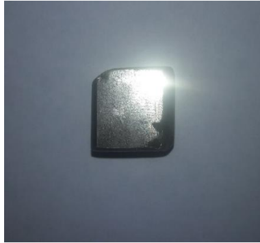
Figura 5.2. Cubo de Pirita utilizado para electrodo de trabajo.
