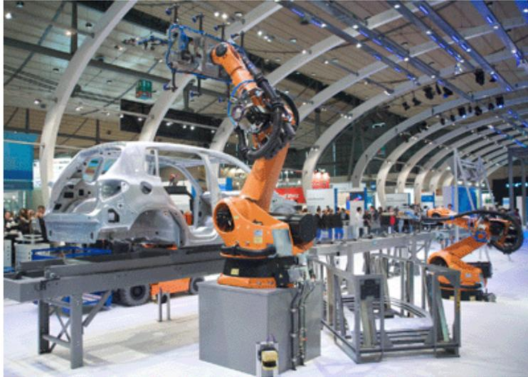
Figura 3.1. Robot poliarticulado trabajando para una ensambladora de coches.
