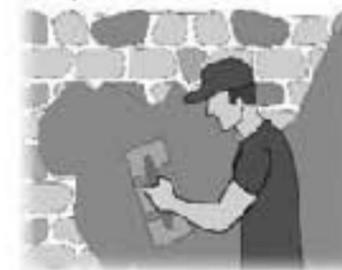
Ilustración del aplanado de cal apagada para el acabado final en los muros que integran la estructura original del edificio de Santo Domingo.
