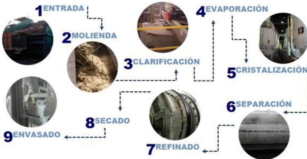
Fig. 2. Diagrama del proceso de obtención de azúcar de caña (IMSA,1991)
