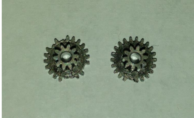
Ilustración 71 fotografía de engranes dañados
