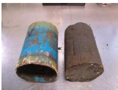
Figura 25. Tubo Shelby de la muestra de suelo No. 2, CH (arcilla de alta plasticidad)
