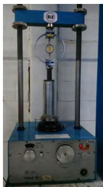
Figura 29. Ensayo de compresión simple
