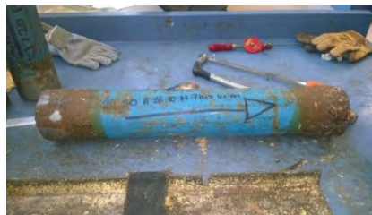
Figura 23. Tubo Shelby de la muestra de suelo No. 1, MH (limo arcilloso de alta plasticidad)
