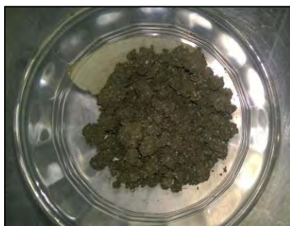
Figura 41. Muestra de suelo natural + rocío de nanosílice
