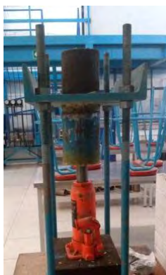
Figura 31. Extracción de la muestra del tubo Shelby
