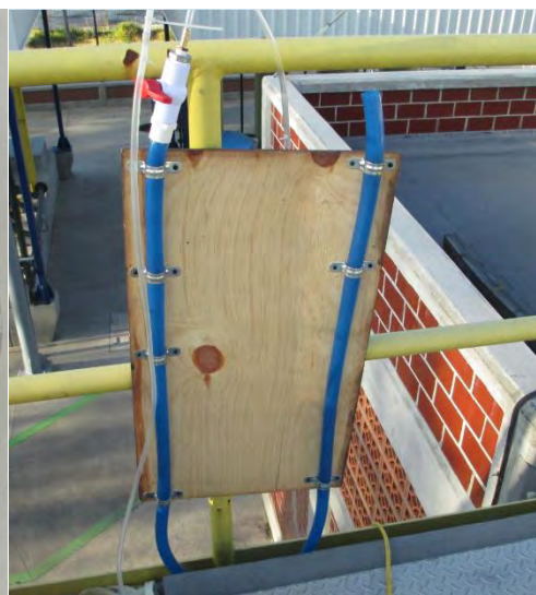
Figura A3.2. Manómetro para la medición de \Delta P en el biofiltro
