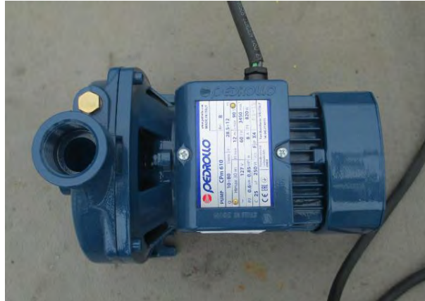
Figura 4.2. Bomba centrífuga utilizada para alimentar la columna de desorción
