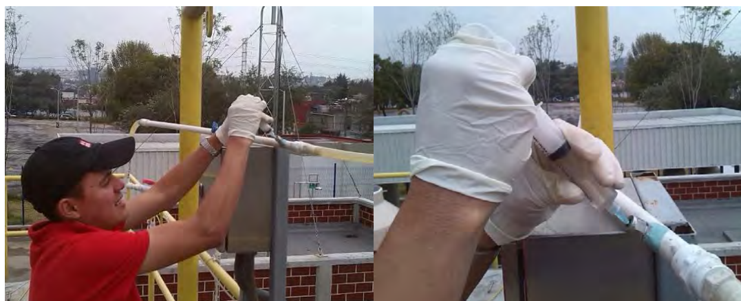
Figura A4.1. Toma de muestra para metano y sulfuro disuelto
