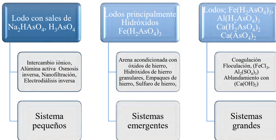
Figura 1.3 Esquematación de tratamientos de remoción de arsénico y posibles residuos, (Sandoval, et al. , 2001)
