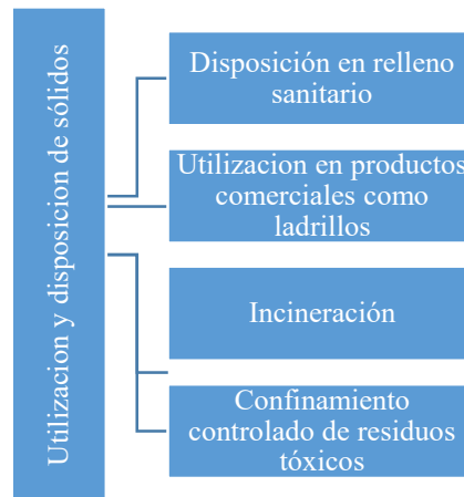
Figura 1.6 Alternativas de disposición y aplicación de estos sólidos, (Fernández Acuña , 2015)
