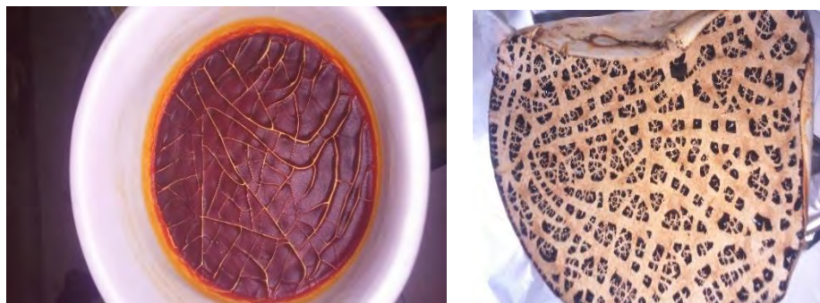
Figura 3.5 Torta quebrada húmeda y torta quebrada seca, para una presión de vacío de 520 mmHg
