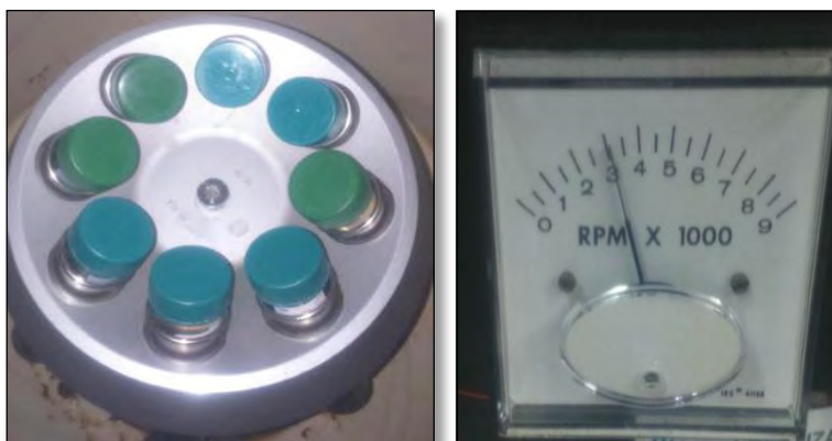
Figura 3.20 Equipo de centrifugación para la deshidratación de lodo
