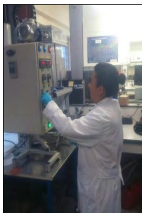
Figura 3.18 Filtro banda, para estudiar la deshidratación de lodo
