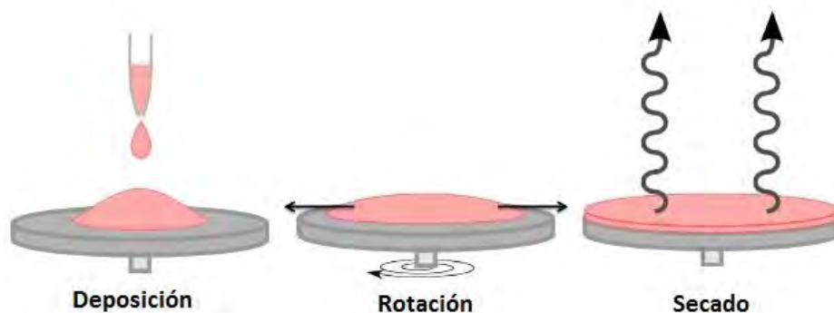
Figura 32. Deposición por Spín Coating
