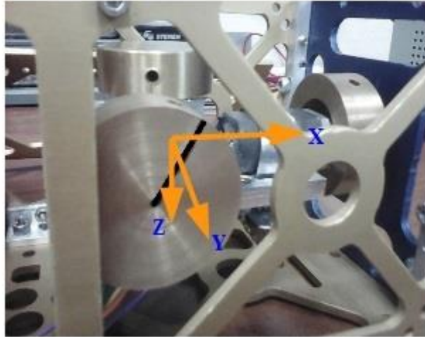
Figura 5-2 Ruedas de reacción colocadas ortogonalmente en el prototipo de satélite.
