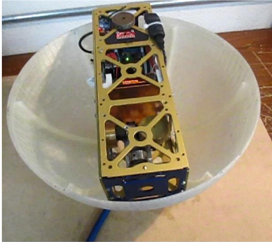
Figura 5-8 Prototipo de un nanosatélite CubeSat 3U, montado sobre un simulador satelital. En esta estructura se encuentra el sistema de control de orientación.
