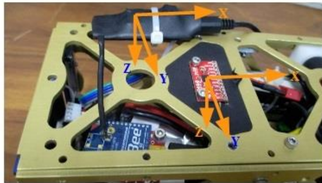
Figura 5-1 Sensores instalados en el prototipo de satélite. Se muestran los sistemas de referencia asociados a los sensores.
