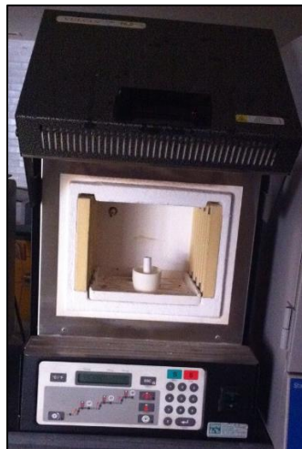
Fotografía 9. Último paso de la muestra. Colocación en la mufla.
