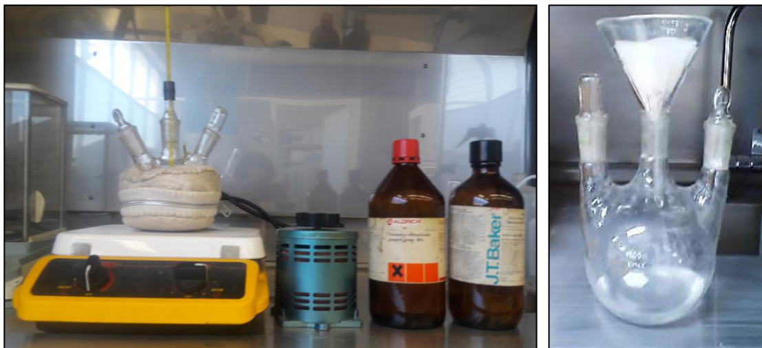
Fotografías 1 y 2. Sistema de Reacción y Filtrado del Sol A2
