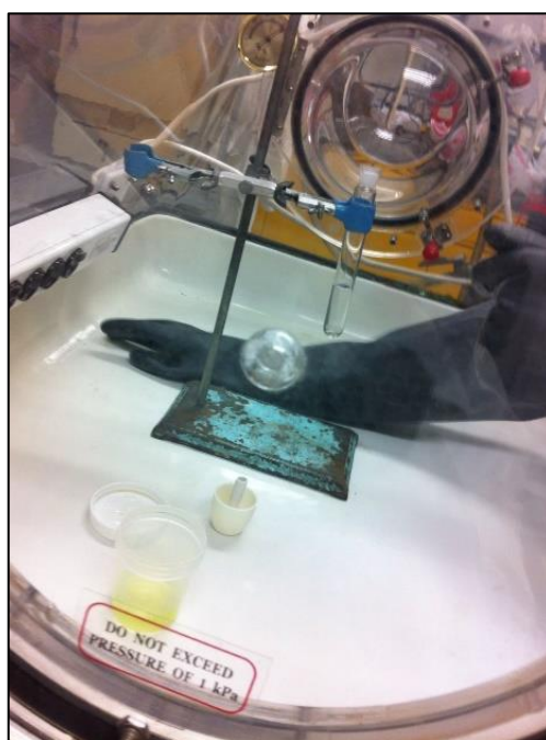
Fotografía 7. Impregnación del sol-gel en el tubo de \alpha -alúmina
