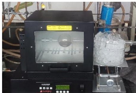
Figura 19. Sistema Kugelrohr de destilación al vacío de la 4VP.
