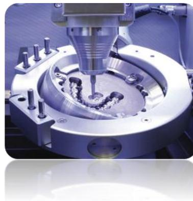
Figura 71. Fabricación de la prótesis libre de metal en un cubo de zirconio (CAM).<sup>26</sup>
