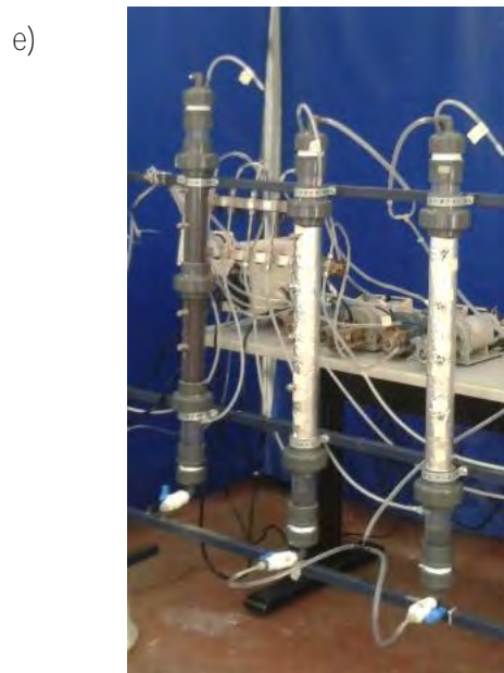
Figura 4.4. Sistema de biofiltración.
