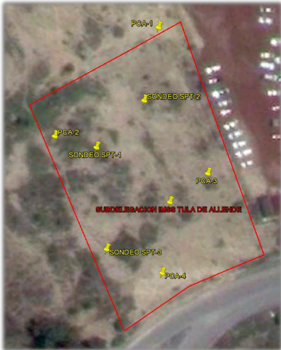
Figura 13 Ubicación del sondeo profundo spt-1 a SPT-3 y de los pozos a cielo abierto PCA-1 a PCA-4
