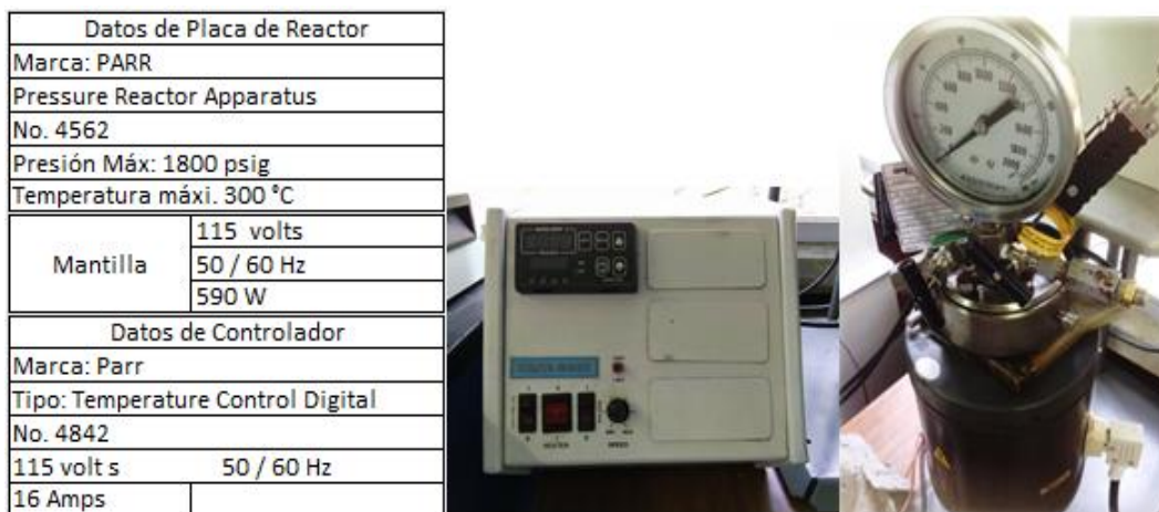
Figura 34. Reactor utilizado en hidrólisis ácida y neutra del BHET.
