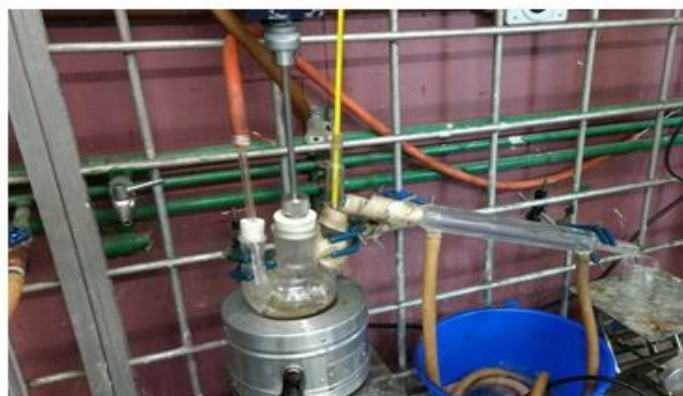
Figura 42. Sistema de reacción de esterificación para la producción de la resina poliéster.
