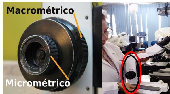
Figura 41 Tornillos macrometricos y micrometricos cuya función es hacer subir la platina hasta alcanzar la distancia de trabajo o distancia de enfoque. Tomada en el laboratorio de microscopía de la Facultad de Estudios Superiores Iztacala.
