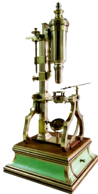
Figura 19 microscopio compuesto monocular de bronce con un cuerpo que se apoya basculando sobre dos arcos de bronce. El tubo se apoya en una columna rectangular, pudiendo alejarse y aproximarse horizontalmente, esta columna se desliza, para el enfoque, sobre otra columna similar que fija el sistema. Recuperado de http://www.librosmaravillosos.com
