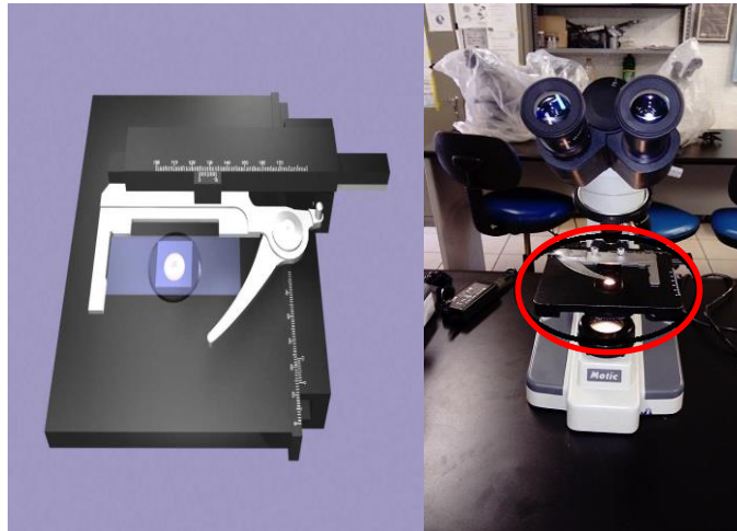
Figura 39 Platina móvil sobre la cual se coloca la muestra a observar. Tomada en el laboratorio de microscopía de la Facultad de Estudios Superiores Iztacala.
