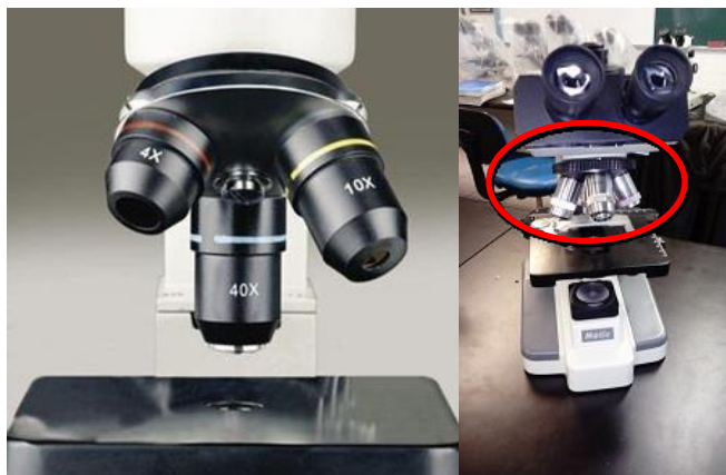
Figura 40 Revólver. Se encuentra en la parte inferior del tubo óptico y en él se encuentran los lentes objetivos, en los microscopios ópticos puede haber tres o cuatro de estos lentes objetivos. Tomada en el laboratorio de microscopía de la Facultad de Estudios Superiores Iztacala.
