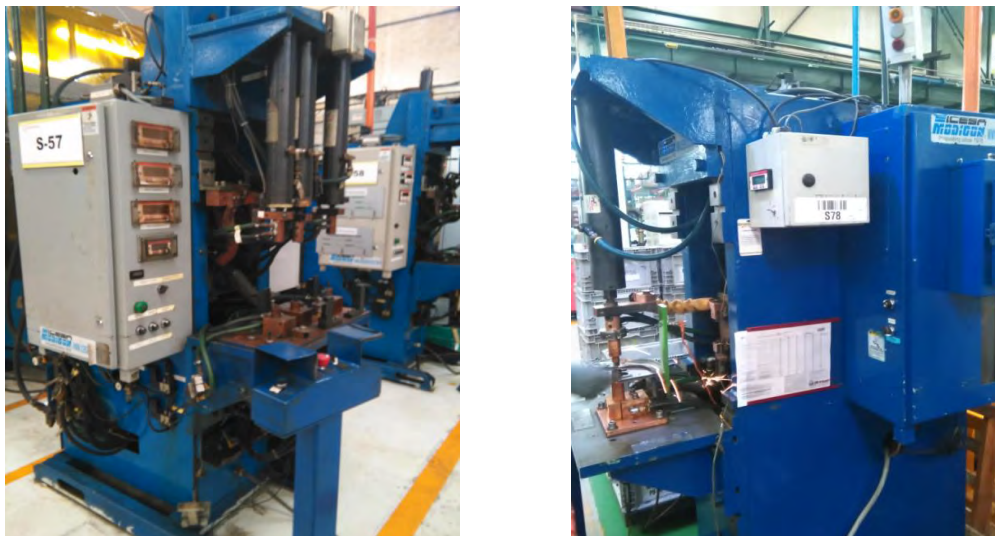
Figura 1.4. Ejemplo de máquinas de la estación de soldadura por presión. Fuente: empresa metalmecánica (2016)
