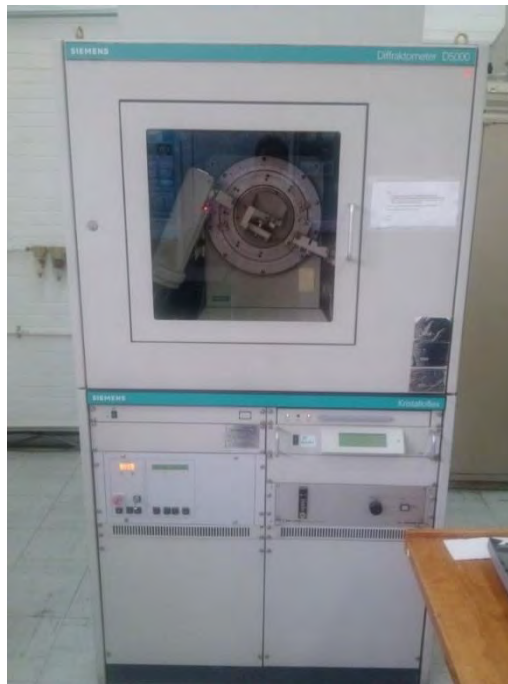
Figura 26. Equipo Diffractometer D 5000 de SIEMENS con lámpara de Cobalto
