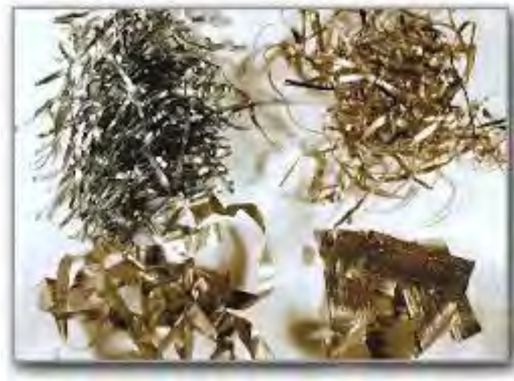
Figura 11. Ejemplos de cintas metálicas vítreas obtenidas mediante "melt-spinning" [63]
