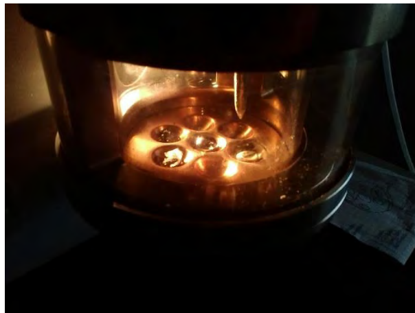
Figura 22. Platina de cobre del horno de arco eléctrico
