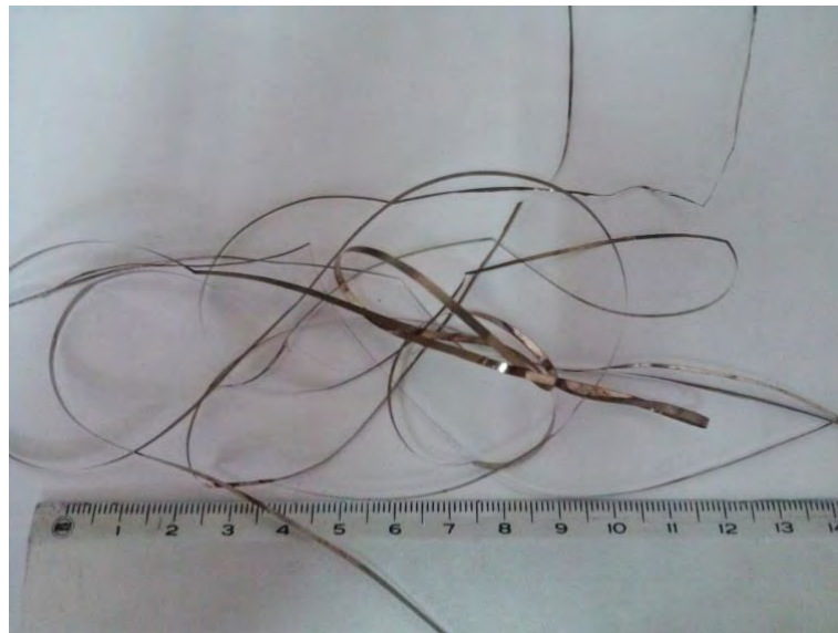
Figura 29. Cintas metálicas vítreas obtenidas mediante la técnica de “melt-spinning”
