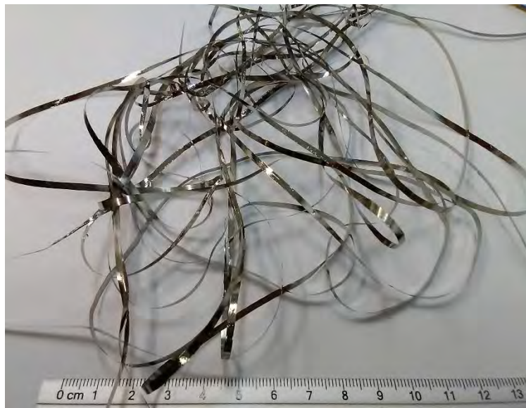
Figura 53. Cintas metálicas vítreas obtenidas mediante la técnica de “melt-spinning”
