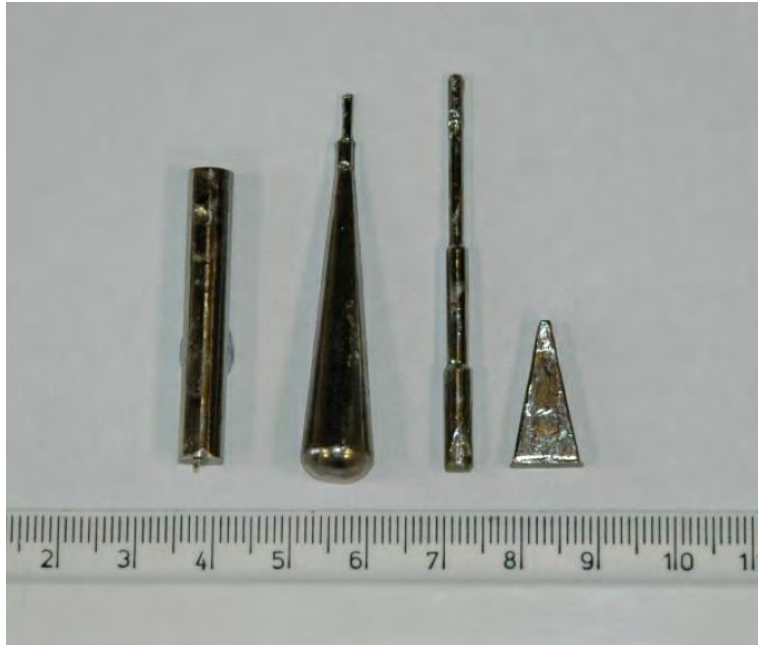
Figura 14. Ejemplos BMG obtenidos mediante succión en molde de cobre [66]
