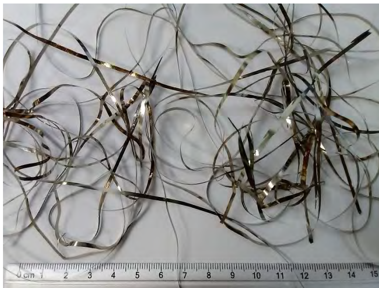
Figura 41. Cintas metálicas vítreas obtenidas
