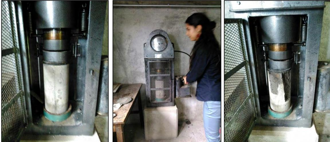
**Fotografía 5.3.1.-** Prueba de resistencia para un espécimen de concreto convencional.
