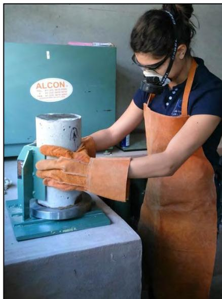
**Fotografía 5.4.10.-** Cabeceador de especímenes con azufre derretido.
