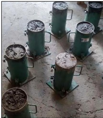
**Fotografía 5.4.7.-** Especímenes al día siguiente de hacerse, listos para desmoldarse y sumergirse en agua
