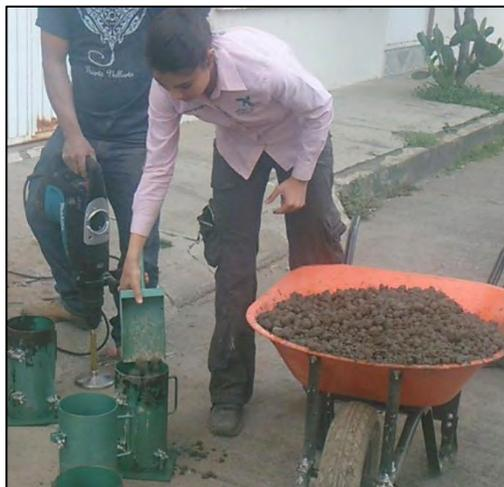
**Fotografía 5.4.4.-** Sirviendo la mezcla de CCR en moldes.
