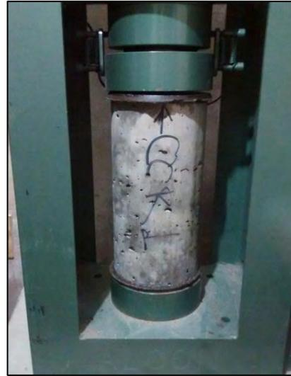
**Fotografía 5.4.12.-** Espécimen colocado en la prensa para realizar la prueba de resistencia
