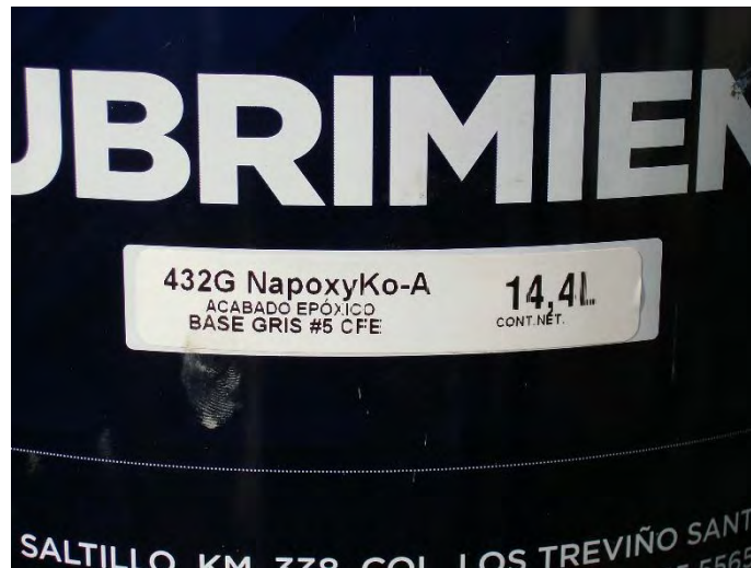
Fotografía 5.2 Acabado epóxico de alto espesor (CFE-A27).
