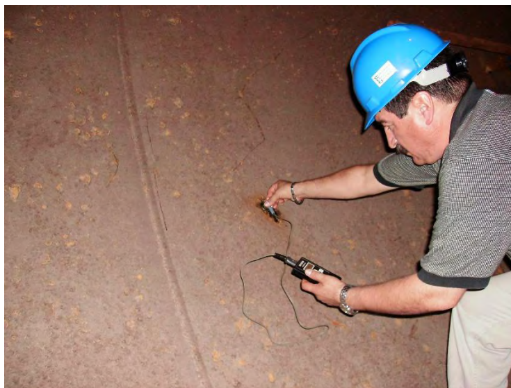
Fotografía 5.1. Medición de espesores de placa por ultrasonido.
