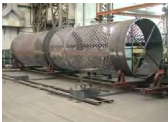
Figura 3-12. Trommel de clasificación-reciclaje. Fuente: Transportadores Universales S. A., 2017.
