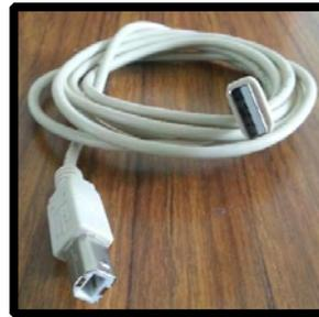
Figura 20 Cable USB tipo A
