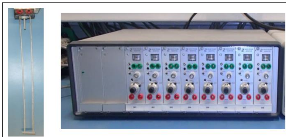
Figura 4-6 Sensor de nivel tipo resistivo (izquierda) y monitor de ocho canales (derecha).
